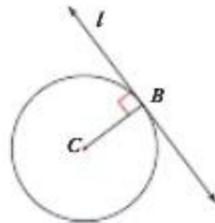
Si la recta  $m$  es tangente a la circunferencia en el punto  $D$ , entonces, el radio  $\overline{OD}$  es perpendicular a  $m$ .
