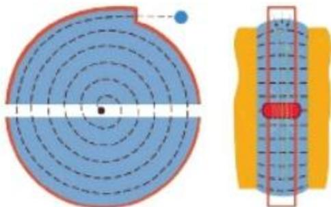
Figura 1. Trayectoria espiral del protón sobre el ciclotrón.
